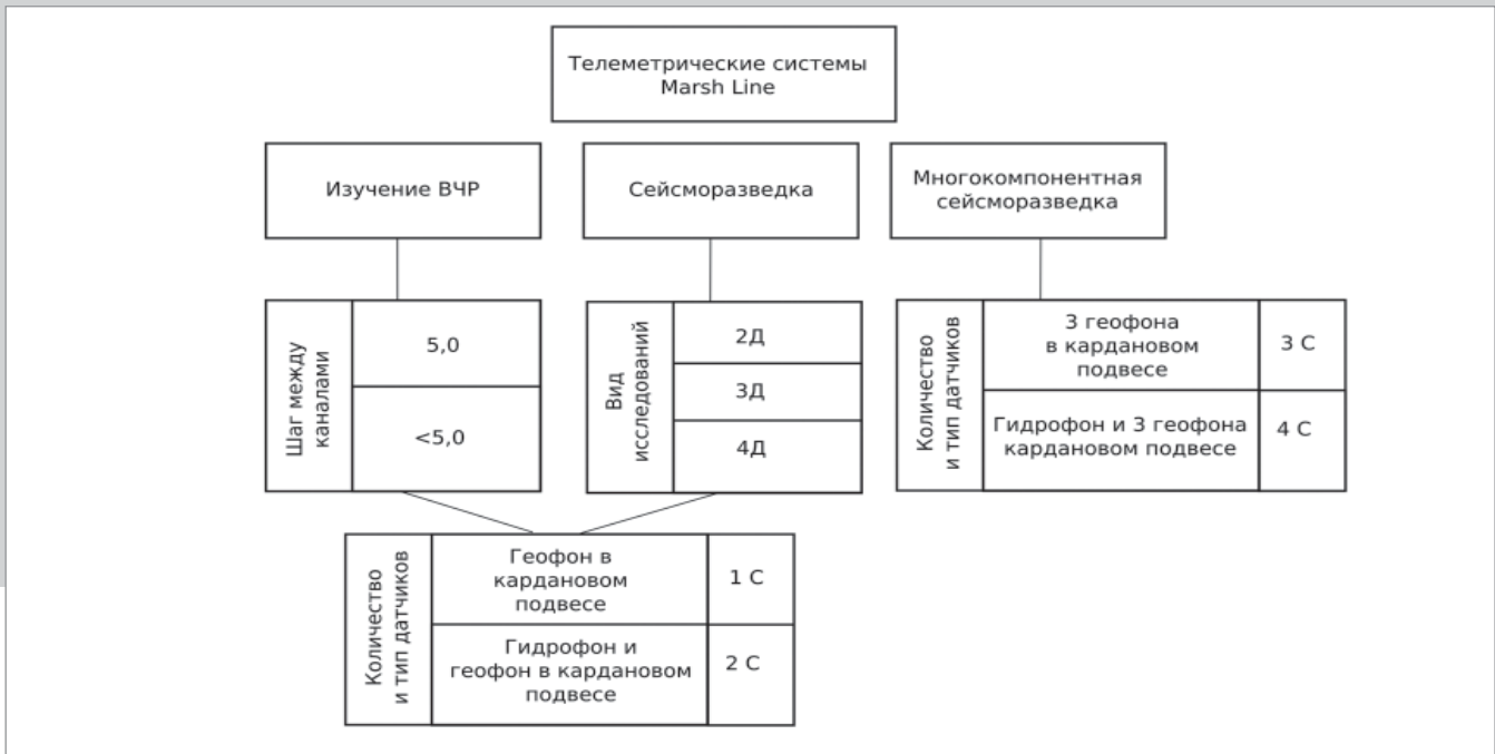
Рис. 3. Виды работ с системой XZone Marsh Line
