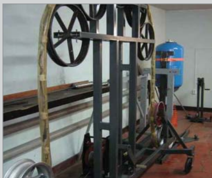
Рис. 5. Установка для заполнения секций косы гелем
